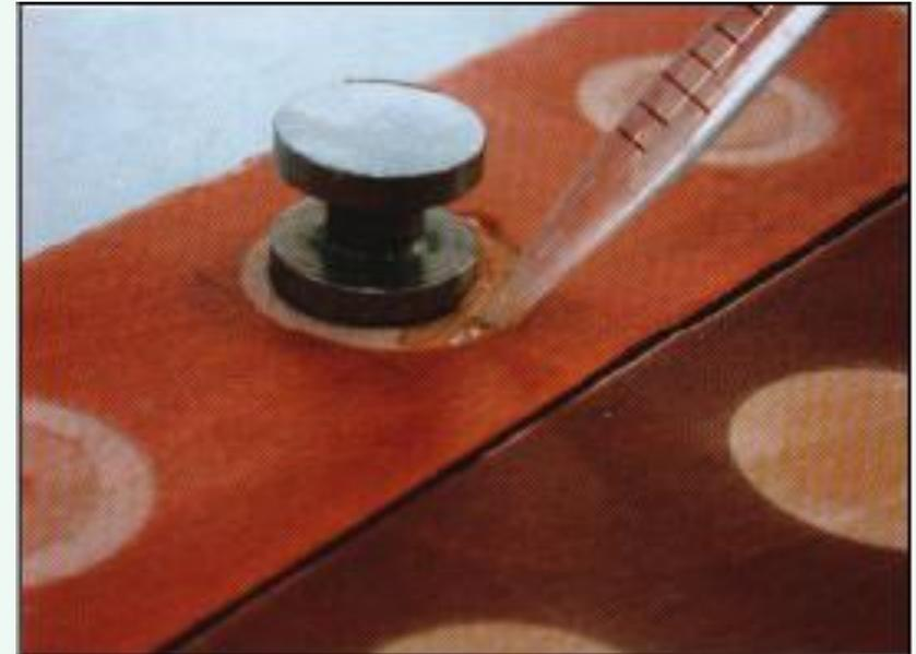
Prova del pull off ad umido (prEN 927-8)
